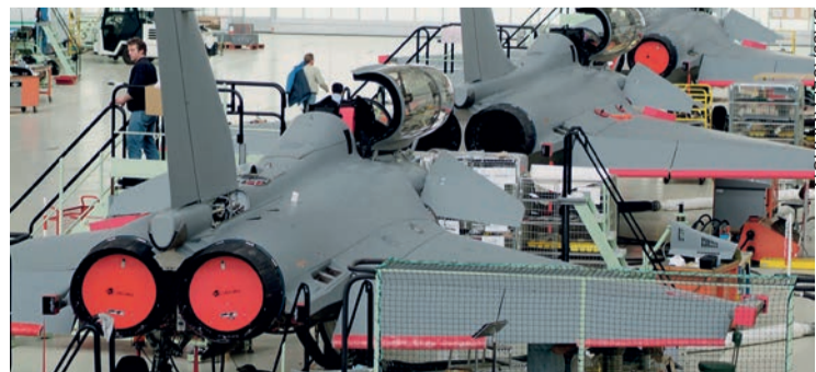
Chaîne d'assemblage final à l'usine de Mérignac.
